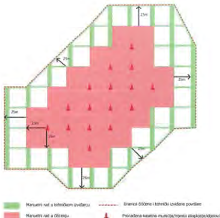
Slika: Grafički prikaz čišćenja i tehničkog izviđanja rizične površine
